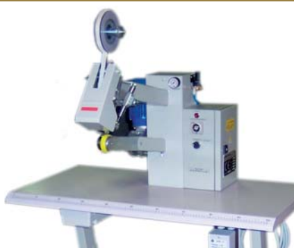
BATTER THE CUTTING LATHER RIM EDGE AND APPLY THE ADHESIVE TAPE BATTICOSTURE E APPLICA NASTRINO DI RINFORZO
