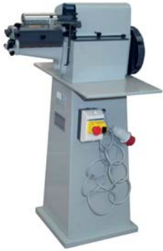
CEMENTING MACHINE FOR INSOLE INCOLLATRICE PER SOTTOPIEDI
