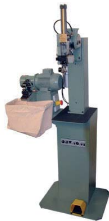
TACK AND TRIMMING INSOLES MACHINE APPLICA E RIFILA SOTTOPIEDI
