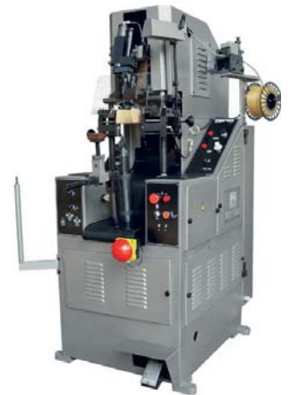
CERIM HYDRAULIC THERMO. HEEL SEAT AND SIDES LASTING MACHINE MONTABOETTE E FIANCHI TUTTO TERMOPLASTICO COMPUTERIZZATA
