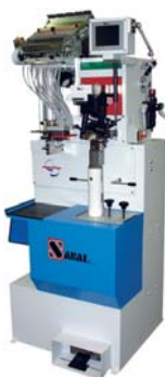
ELECTRONIC HEEL NAILING MACHINE INCHIODATACCHI ELETTRONICA CON TOUCH SCREEN
