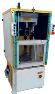
ELECTRONIC SOUNDPROOF HEEL SEAT POUNDING MACHINE BOETTATRICE CON CABINA INSONORIZZATA
